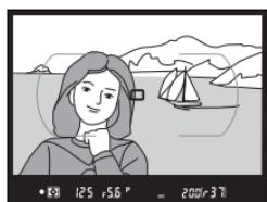
Anschließend kann die Messfeldvorwahl wieder mit dem Sperrschatzter gesperrt werden (Position L), um ein versehentliches Verstellen des vorgewählten Fokusmessfelds zu verhindern.
