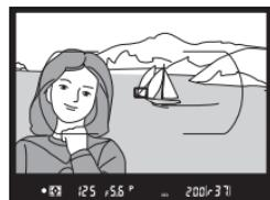
Wenn Sie den Auslöser nach einer Aufnahme nur bis zum ersten Druckpunkt zurückbewegen und in dieser Position gedrückt halten, bleibt bei allen folgenden Aufnahmen die gemessene Entfernung gespeichert. Solange Sie die Taste **AE-L/AF-L** gedrückt halten, bleibt die gemessene Entfernung auch nach dem Auslösen der Kamera gespeichert.
